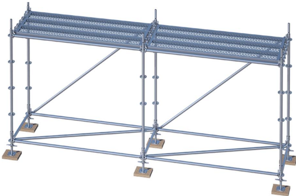
Εικόνα 5: Παράδειγμα σκαλωσιάς με 3 μεταλλικά δάπεδα κατά πλάτος.
